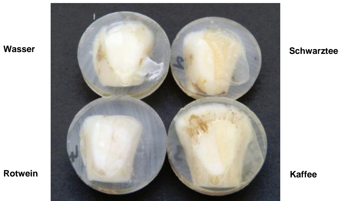
Abb. 14: Verfärbungstest mit Cervitec F: Nach 5 Minuten Lagerung in Wasser – Schwarztee – Kaffee – Rotwein (im Uhrzeigersinn, beginnend von oben links) ist nur eine leichte Verfärbung nach Kontakt mit Schwarztee und Kaffee zu erkennen.
