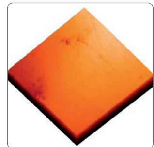
Oberflächenrauigkeit nach abschliessender Politur Surface roughness after final polishing
