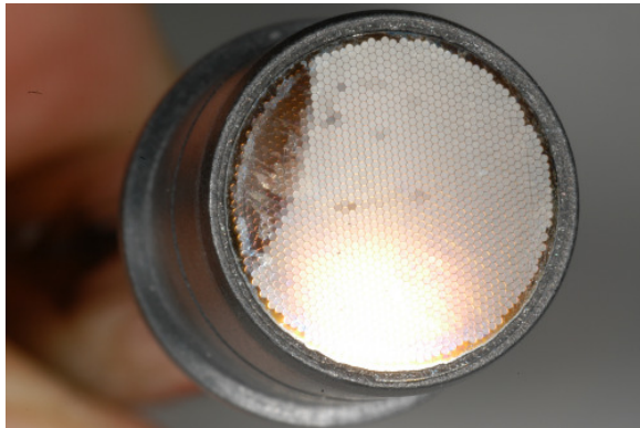
Abb. 4. Defekter Lichtleiter. Die dunklen Fasern stehen für einen Transport des Lichtes nicht mehr zur Verfügung.
