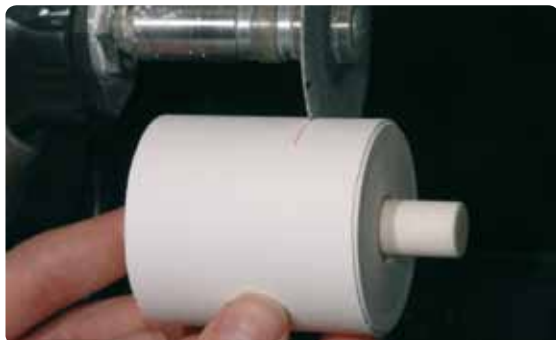
Muffel anschließend an der markierten Stelle mit einer Trennscheibe trennen.
