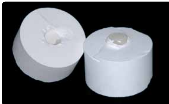
Muffel anschließend an der markierten Stelle mit einer Trennscheibe trennen.
