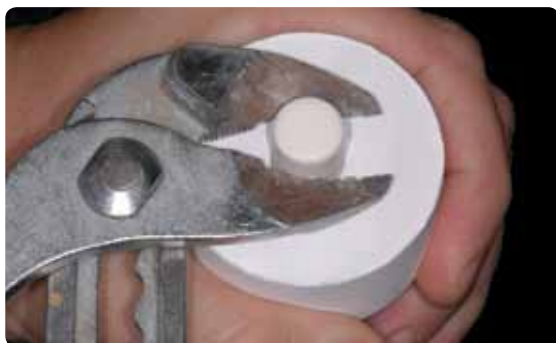
Dreht man den Alox-Kolben vorsichtig mit einer Zange aus der Einbettmasse so erhält man ihn bereits sehr sauber. Jedenfalls auf Sauberkeit überprüfen, ggfs. sandstrahlen mit Al_2O_3
