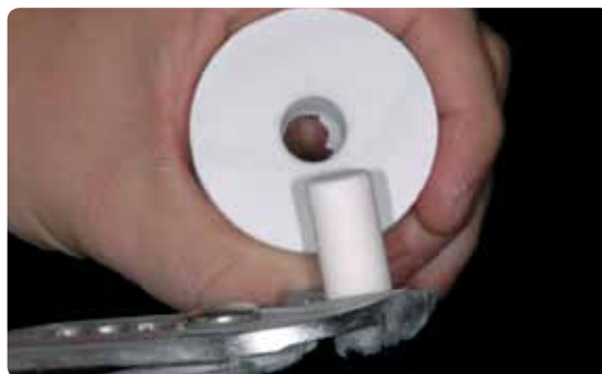
Dreht man den Alox-Kolben vorsichtig mit einer Zange aus der Einbettmasse so erhält man ihn bereits sehr sauber. Jedenfalls auf Sauberkeit überprüfen, ggfs. sandstrahlen mit Al_2O_3
