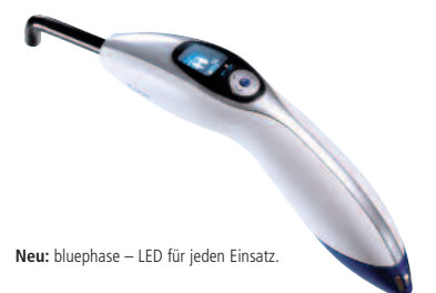
Jedes Material dank polywave LED: Durch die Verwendung von 2 unterschiedlichen LEDs, dominant bei ca. 410 nm und ca. 470 nm, werden alle lichthärtenden Materialien ausgehärtet.
