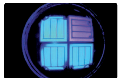
Jedes Material dank polywave LED: Durch die Verwendung von 2 unterschiedlichen LEDs, dominant bei ca. 410 nm und ca. 470 nm, werden alle lichthärtenden Materialien ausgehärtet.
