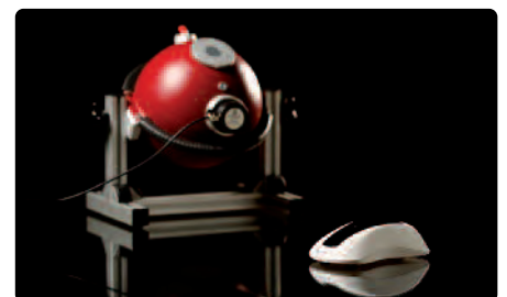
Die Ulbrichtkugel (links) und das bluephase meter (rechts) im Test.
