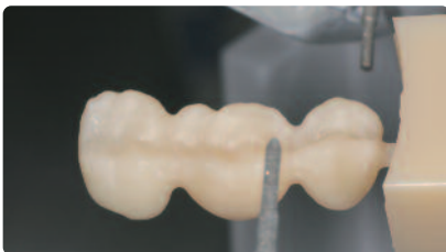
Telio CAD Restauration nach dem Schleifvorgang im CAD/CAM Gerät und beim Abtrennen am Zapfen
