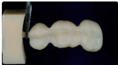
Telio CAD Restauration nach dem Schleifvorgang im CAD/CAM Gerät und beim Abtrennen am Zapfen
