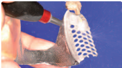
Abstrahlen mit \text{Al}_2\text{O}_3 , 100 \mu\text{m} mit 2–4 bar Druck
