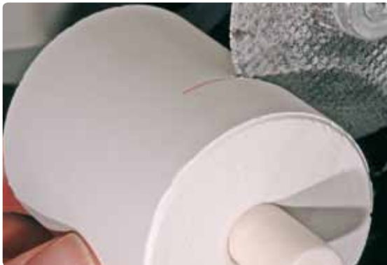
Muffel mit einer Trennscheibe separieren und an der Sollbruchstelle brechen.
