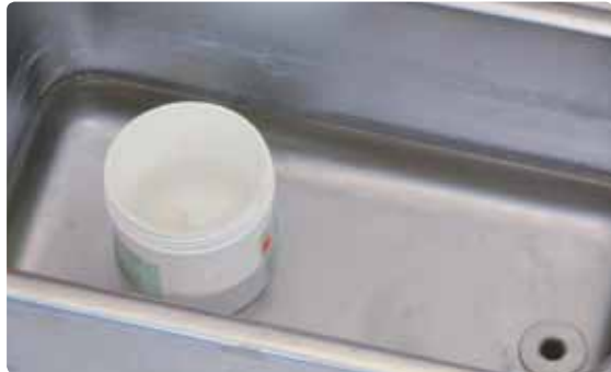
... und für mindestens 10 Minuten bis maximal 30 Minuten im Ultraschallbad absäuern.
