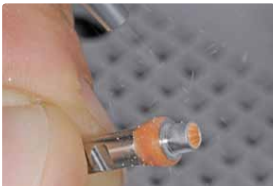
Vorsichtiges Abstrahlen der Klebefläche mit \text{Al}_2\text{O}_3 50–100 \mu\text{m} bei geringem Druck bis eine gleichmässig matte Oberfläche erreicht ist.
