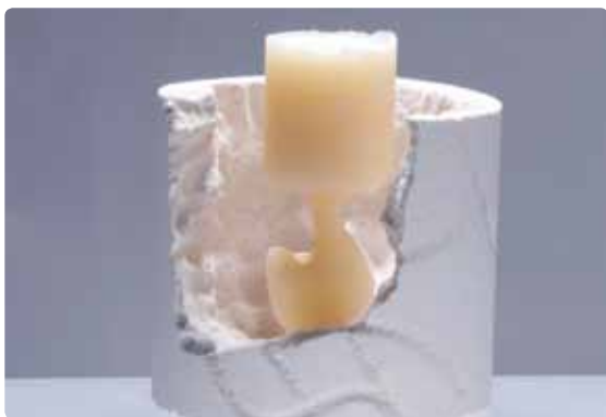
Die Feinausbettung der Abutment-Krone erfolgt mit Glanzstrahlmittel bei 2 bar Druck.
