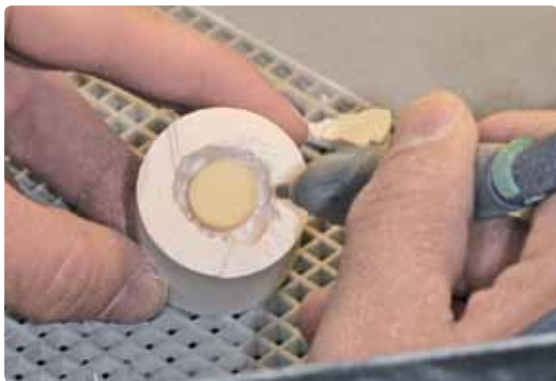
Die Grobausbettung erfolgt mit Glanzstrahlmittel bei 4 bar Druck bis das Objekt sichtbar wird.
