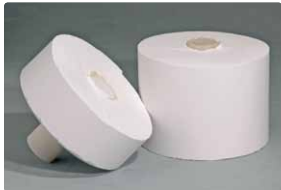
Muffel mit einer Trennscheibe separieren und an der Sollbruchstelle brechen.
