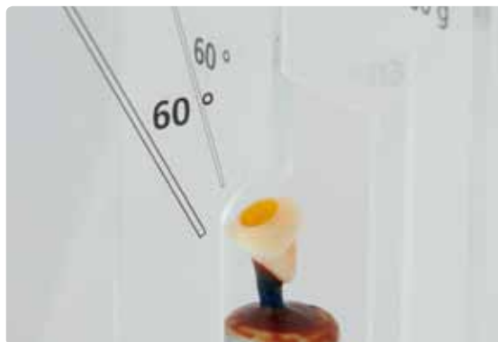
Ausrichtung der Modellation auf der Muffelbasis, sodass der Schraubenkanal parallel zur Aussenwandung der Muffel steht. Hierdurch kann nachfolgend ein gleichmässiges, kontrolliertes Einfüllen der Einbettmasse erreicht werden. Zusätzlich wird das Risiko des Abbrechens der Einbettmasse im Schraubenkanal beim Einpressen der Keramik verringert.
