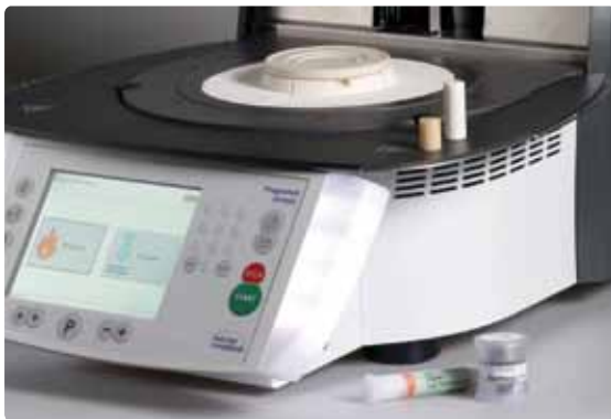
Kalten isolierten IPS Alox-Kolben und kalten IPS e.max Press Rohling in der gewünschten Farbe bereitstellen.
