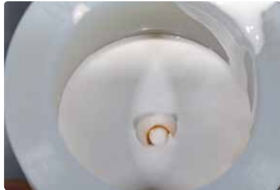
Die Einbettmasse langsam in die Muffel einfüllen, so dass diese im Schraubenkanal kontinuierlich aufsteigen kann!
