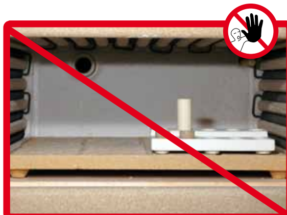
IPS e.max Press Rohling und Alox Kolben nicht vorwärmen.
