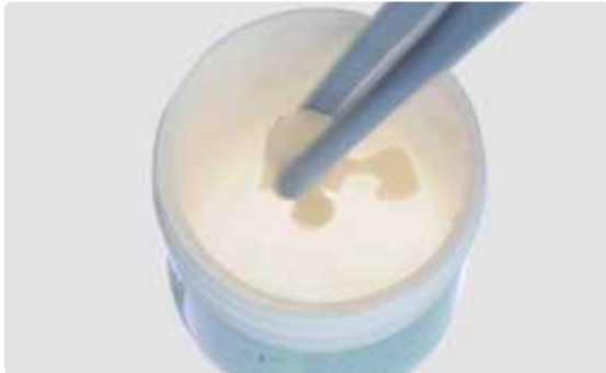
Zum Entfernen der Reaktionsschicht die Pressobjekte in das IPS e.max Press Invex legen...
