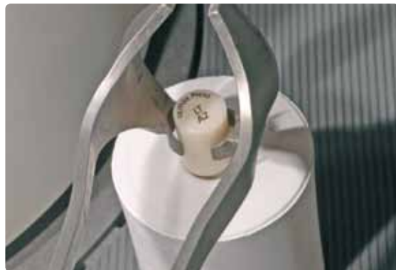
Kalten IPS e.max Press Rohling mit der bedruckten Seite nach oben in die heisse Muffel geben.
