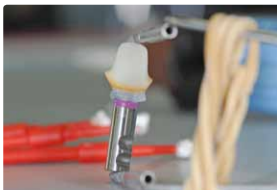
Aushärtung des Befestigungscomposites für 7 Minuten (optional in einem Lichtpolymerisationsgerät). Wichtig: Bis zum Abschluss der Polymerisation die Objekte nicht bewegen und in der Lage bewegungsfrei fixieren.
