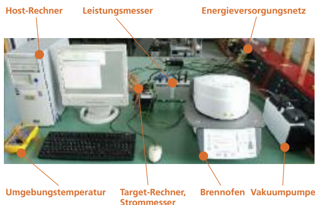
Abb. 1. Foto des Messaufbaus
